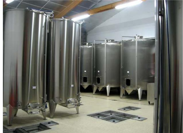
Edelstahlgebinde und die Bodenöffnungen zu unterirdischen cuves.
